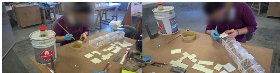
Collage maquette à la colle néoprène liquide
