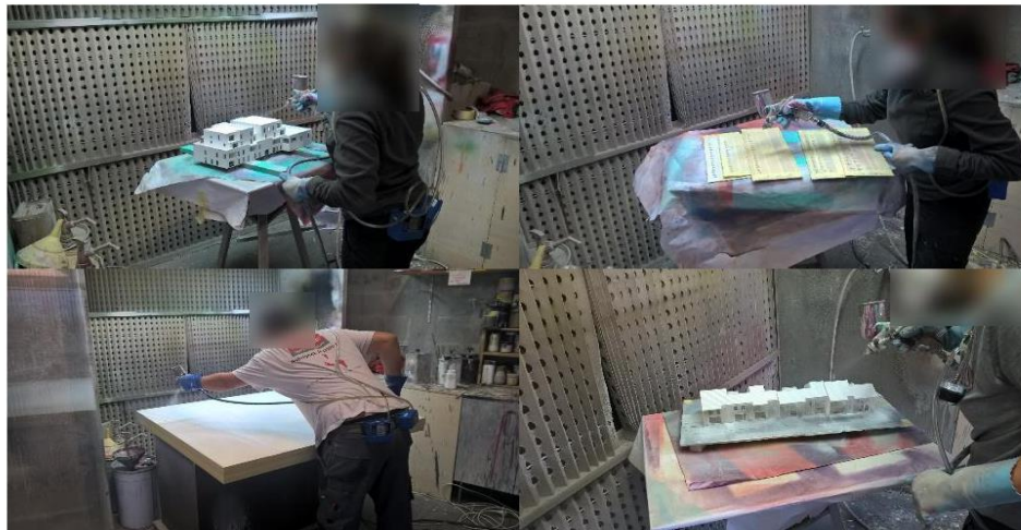
Projection de peinture devant le fronton d'aspiration
