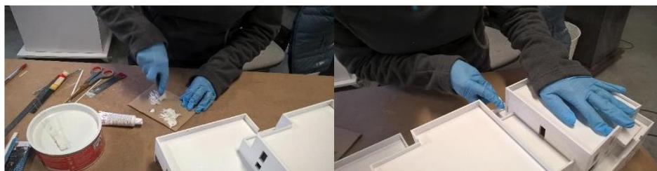
Collage au SYNTOFER, mélange mastic + durcisseur, application
