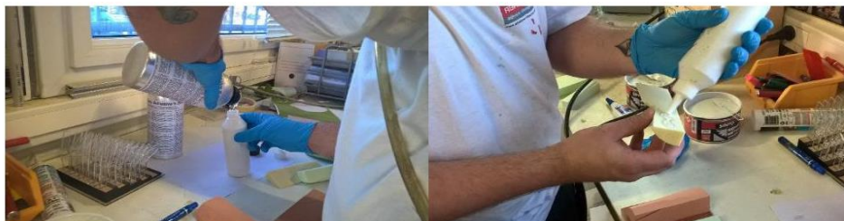
Collage bi-composants d'une mousse en résine
