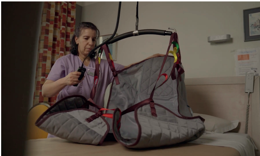
Système de transfert de patient avec rails et assistance électrique pour prévenir les TMS de l'aide-soignante.
